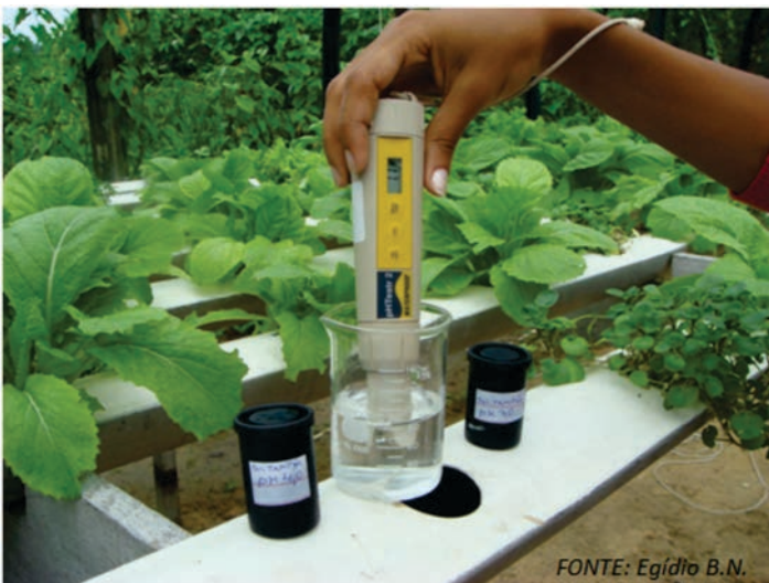
Figura 7. Medição do pH da solução nutritiva empregada no cultivo hidropônico de hortaliças folhosas.
